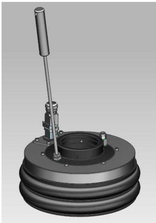
压盘主体整体6061变形铝合金切削制造，
